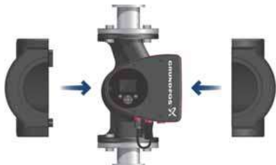
Fig. 60 Montaggio gusci isolanti su pompa MAGNA3
