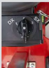
Interruttore con invertitore di direzione
