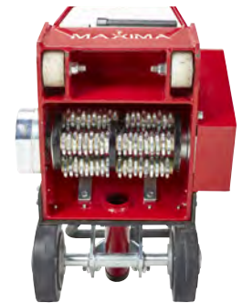
Quattro ruote di appoggio per una migliore stabilità
