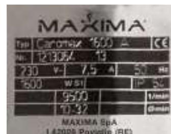
Motore ad alta velocità: 9500 Giri / Min
