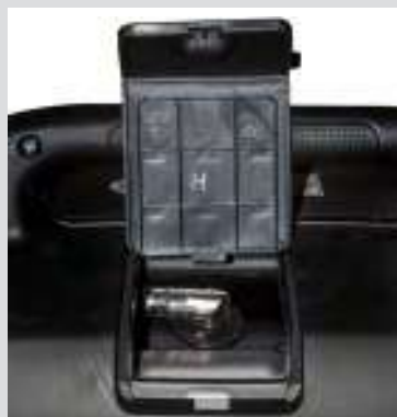
Facile accesso per la manutenzione della candela
