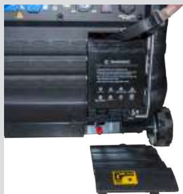
Batteria ad acido per l'accensione elettrica
