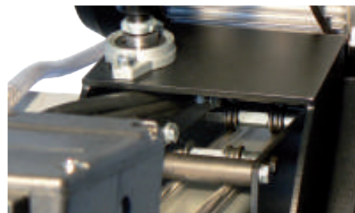
Scorrimento su cuscinetti doppi in acciaio su quattro barre in acciaio
