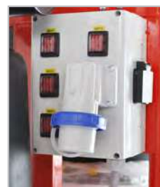
Monofase a 3 motori più 1 motore scuotifiltro
