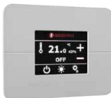
Termostato ambiente touch-screen per il controllo della temperatura e umidità ambiente. Colore bianco. Da utilizzare con collegamento via Bus al modulo di regolazione KPM30. Possibilità di comandare direttamente un fan-coil a 3 velocità in combinazione con modulo KF201. Alimentazione 12 Vdc. Installazione orizzontale su scatola a tre moduli a standard italiano o a parete. Protocollo di comunicazione Bus RS485 Modbus RTU. Campo di misura 5÷50 °C.
