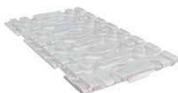
Pannelli isolanti di testata in polistirene espanso, per il passaggio delle tubazioni di adduzione e il supporto delle curvature dei circuiti, in impianti radianti a pavimento a secco. Dotato di incastri sui quattro lati per accoppiamento con i pannelli adiacenti. Dimensioni utili 600x300 mm.
