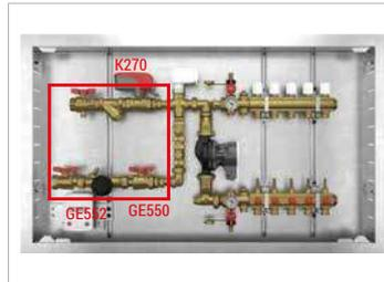
Collettore premontato con regolazione elettronica tramite valvola miscelatrice. In ottone, con attacchi per adattatore tubo rame, plastica o multistrato. Alimentato con acqua ad alta temperatura. Il controllo della temperatura è di tipo elettronico, con l'attuatore K281X012 (da ordinare separatamente) gestito dalla termoregolazione KLIMAbus. Campo di temperatura 5÷110 °C. Pressione massima di esercizio 6 bar. Cassetta di contenimento da 110 mm di spessore e 605 mm di altezza. Composto da:
