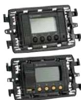
Termostato ambiente elettronico, installazione a parete da incasso. Alimentazione 230 V / 50 Hz. Portata contatti 5(3)A, 250 Vca. Grado di protezione IP20. Display con icone grafiche abbinata ai tasti frontali, per scelta della modalità di funzionamento: comfort, economy, off/antigelo. Contatto in commutazione libero da tensione. Classificazione dei dispositivi di controllo della temperatura secondo Reg.(EU) N.811/2013-813/2013: classe energetica IV, 2%.
