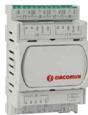
Modulo di espansione ingressi/uscite per modulo di regolazione KPM30. Uscite a contatti liberi da tensione con possibilità di comando attuatori elettrotermici, servomotori per valvole di zona oppure sistemi di trattamento aria per deumidificazione o integrazione. Alimentazione a 24 Vac. Dimensioni 4 moduli DIN.
