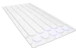
Pannello in fibro-gesso, per impianti a pavimento radiante a basso spessore. Passo di posa del tubo: 10 cm. Densità: 1150 kg/m<sup>3</sup>. Per tubazioni con Ø 12 mm. Dimensioni 1200x600 mm.
