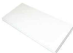
Pannello isolante piano per impianti a pavimento radiante. Realizzato in polistirene espanso estruso (XPS300 o XPS500) con superficie liscia e bordi laterali battentati. Conduttività termica: 0,034 W/m K. Dimensioni utili: 1250x600 mm.
