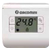
Termostato ambiente, installazione a parete da esterno. Display senza retroilluminazione. Alimentazione a batterie. Relè di uscita con contatto di scambio libero da tensione, 5(3) A, 250 Vac. Modalità di funzionamento in riscaldamento e raffreddamento con 2 livelli di attenuazione. Scala di regolazione temperatura 2÷40 °C. Differenziale 0,5 K. Grado di protezione IP20. Classificazione dei dispositivi di controllo della temperatura secondo Reg.(EU) N.811/2013-813/2013: classe energetica IV, 2%.
