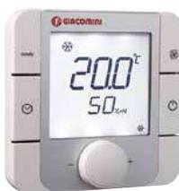
Termostato ambiente con display retroilluminato ed interfaccia locale per il controllo della temperatura e umidità ambiente. Da utilizzare con collegamento via bus al modulo di regolazione KPM30. Alimentazione 230 Vac, comunicazione Modbus RTU slave su RS485. Installazione da incasso in scatola civile tonda.
