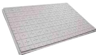
Pannello isolante preformato piano per impianti a pavimento radiante. Realizzato in polistirene espanso sinterizzato (EPS) autoestinguento ad alta densità, accoppiato con strato di protezione in polietilene termoformato antiurto con funzione aggiuntiva di barriera al vapore. Griglia preformata con indicazione dei passi di posa: 50x50 mm e 100x100 mm. Conduttività termica: 0,033 W/m K (EPS200). Dimensioni utili: 1200x800 mm.
