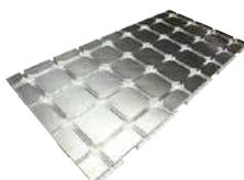
Pannello isolante in polistirene espanso per impianti radianti a pavimento a secco. Accoppiato ad incastro con un profilo termoconduttore costituito da una lamina di alluminio spessore 0,3 mm, consente il passaggio delle tubazioni in entrambe le direzioni ed eventualmente a 45° (rimuovendo una parte presagomata del lamierino). Dotato di incastri sui quattro lati per accoppiamento con i pannelli adiacenti. Passo di posa 150 mm. Per tubazioni con Ø 16÷17 mm. Dimensioni utili 1200x600 mm.
