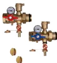
Kit collettore premontato e valvole multifunzione, per impianti di climatizzazione, con misuratori di portata (0,5÷5 l/min). In ottone, con attacchi per adattatori tubo rame, plastica o multistrato.
