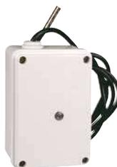
Termostato di sicurezza con sonda a immersione, completo di pozzetto R227-1 per sonda di mandata. Temperatura di intervento impostata 50 °C. Alimentazione 230 V, 50 Hz. Campo controllo temperatura 40÷80 °C.
