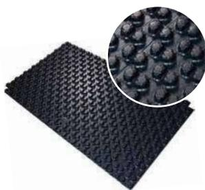
Pannello isolante preformato bugnato per pavimenti radianti con possibilità di posa diagonale delle tubazioni. Realizzato in polistirene espanso sinterizzato con grafite (EPS150 per R979TG003, EPS T per R979TG005 e R979TG006), con strato di protezione in polistirene termoformato nero. Passo di posa: multipli di 50 mm.
