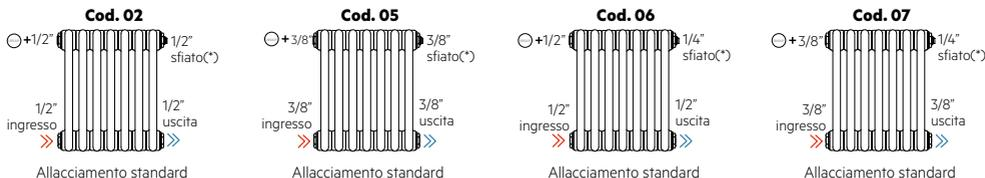
Per batterie TESI con altezza superiore a 1000 mm o per batterie con meno di 15 elementi inserire diaframma sul lato ingresso acqua. Vedi allacciamenti riportati sotto cod. 08, 09, 10, 11.
