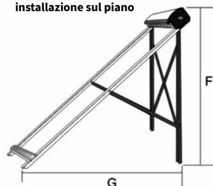
Telaio: installazione sul piano
